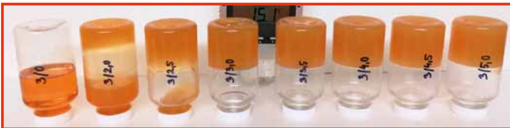
OBRÁZOK 1: Test imobility oleogélu pri vertikálnom obrátení kontajnera.
